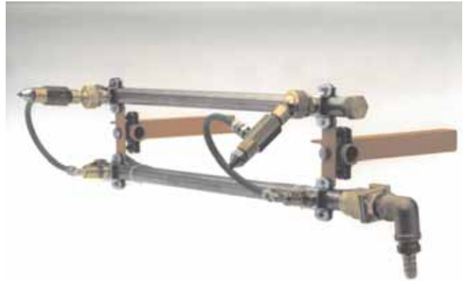
Düsenstock: Rohrlänge und Düsenanzahl variabel
