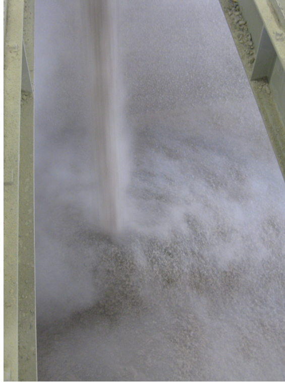
Ohne DUSTEX®: sichtbarer Staub im Aufprallbereich
