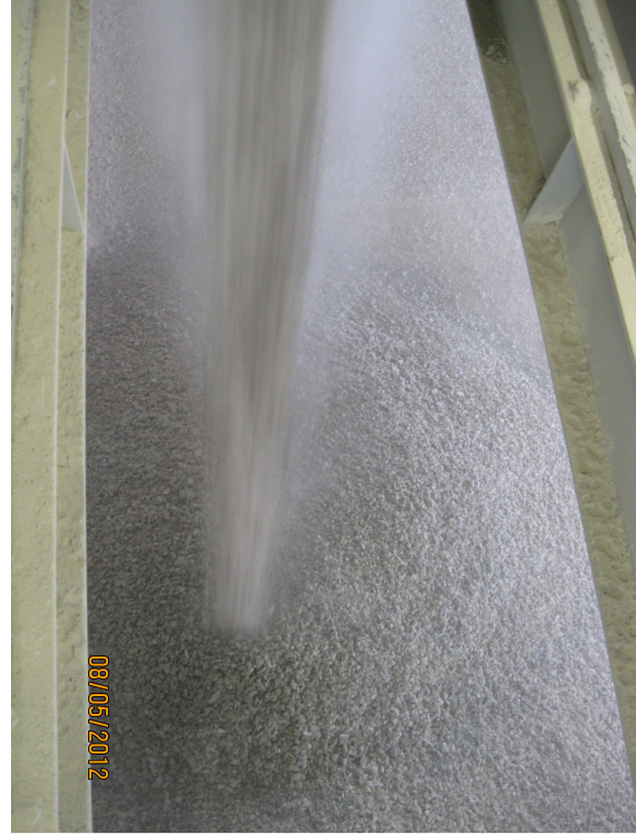
Mit DUSTEX®: kein sichtbarer Staub mehr im Aufprallbereich
