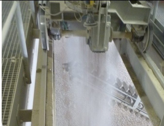
Bandabwurf vom verfahrbaren Reversierband mit aktiviertem DUSTEX® Dispersionssystem.
